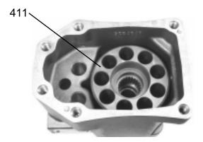
8. Install the Cylinder Barrel (item 411).
