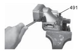
Fasten the 4 boults (item 491) to specified torque.
